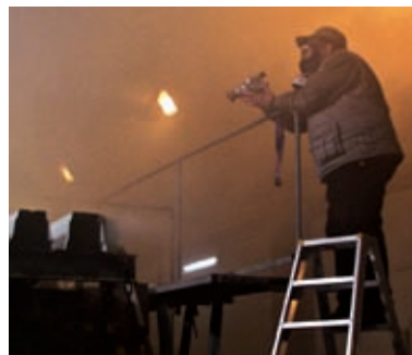
Test strechy s izoláciou PIR. Intenzívny vývin dymu trval až do vzplanutia izolačných dosiek. (obr. 25)
