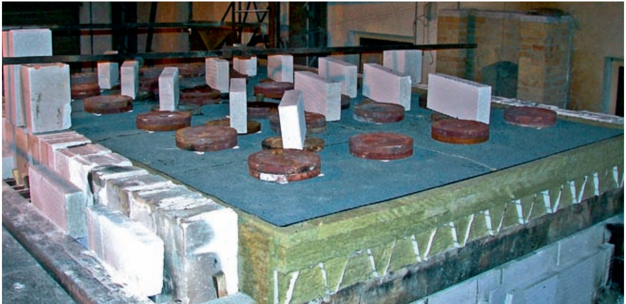
Strešná konštrukcia používajúca dvojvrstvový izolačný materiál Monrock MAX E pri testovaní podľa STN EN 1365-2 (obr. 19)
