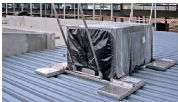
Manipulačný vozík Lift & Roller. Ľahký rozložiteľný vozík na transport palet s izoláciami po streche. Poloha pred zdvihnutím palety (obr. 55)
