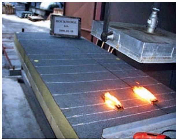
Test vystavenia strechy vonkajšiemu požiaru podľa STN P ENV 1187/A1. Trieda B ROOF (t3) v praxi: nulové šírenie požiaru po streche či cez izoláciu Monrock MAX E po dobu 60 minút (obr. 22)
