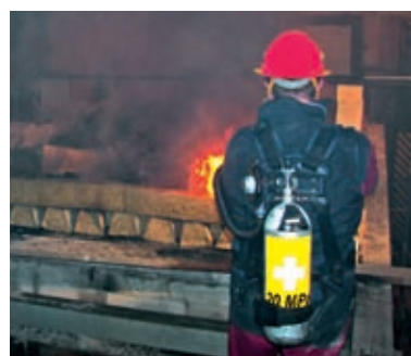
Test strechy s dvoma vrstvami izolácie: 4 cm Rockwool a 12 cm EPS. Opakované hasenie plameňov v mieste porušenia celistvosti strechy. (obr. 24)
