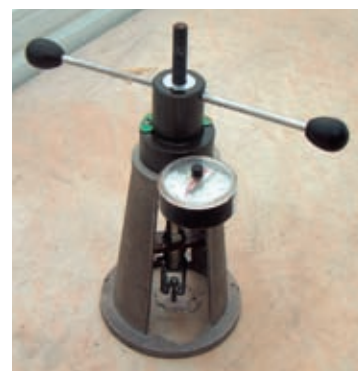
Výťažná skúška kotevného prvku mechanické kotvy. (obr. 49)
