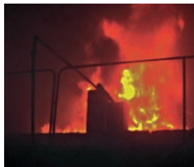
Náhle vzplanutie celého povrchu vzorky strechy s izoláciou z EPS po 10 minútach testu. (obr. 23)
