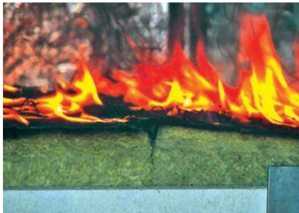
Vystavenie strechy vonkajšiemu požiaru, test podľa STN P ENV 1187. Trieda B ROOF (t4) v praxi: nulový prienik požiaru z horiacej hydroizolácie cez materiál Monrock MAX E hrúbky 80 mm po dobu 60 minút (obr. 20)
