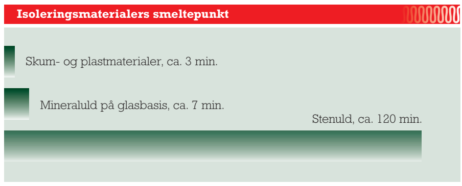
Figur 2: Søjlerne angiver, hvor lang tid det varer inden forskellige isoleringsmaterialers smeltepunkt nås, når materialerne brandpåvirkes svarende til standardbrandkurven.
