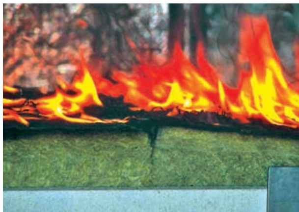
Vystavení střechy vnějšímu požáru, test podle STN P ENV 1187. Třída B ROOF (t4) v praxi: nulový průnik požáru z hořící hydroizolace přes materiál Monrock MAX E tloušťky 80 mm po dobu 60 minut (obr. 20)
