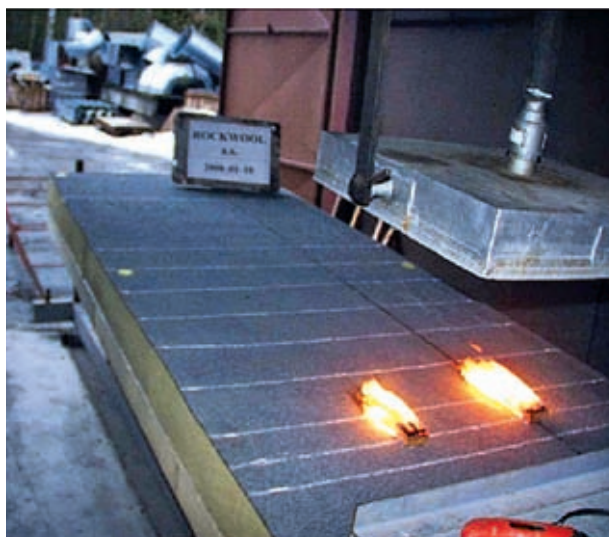
Test vystavení střechy vnějšímu požáru podle ČSN P ENV 1187/A1. Třída B ROOF (t3) v praxi: nulové šíření požáru po střeše nebo přes izolaci Monrock MAX E po dobu 60 minut (obr. 22)
