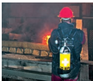
Test střechy se dvěma vrstvami izolace: 4 cm Rockwool a 12 cm EPS. Opakované hašení plamenů v místě porušení celistvosti střechy. (obr. 24)
